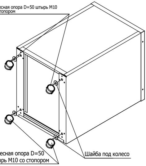
Колесная опора D=50 штырь M10 со стопором
